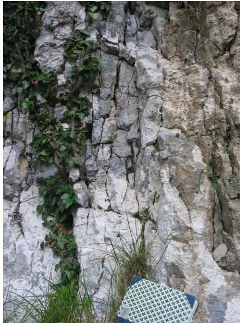
Figura 14 - Sistemi di fratture subverticali anastomizzate e ad apertura variabile nel Calcare del Monte Spitz
