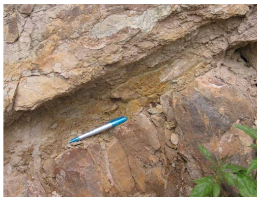
Figura 17 – Gouge argilloso impermeabile sviluppato su piano di faglia a basso angolo
