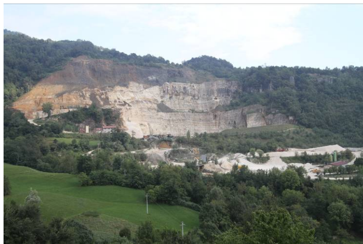
Figura 25 – Panoramica sulla Cava “Bertocchi” sinistra idrografica della media Valle del Chiampo l’attività estrattiva ha messo in esposizione il limite tra le vulcaniti basaltiche (scure) e il tetto dei calcari chiari oggetto della coltivazione
